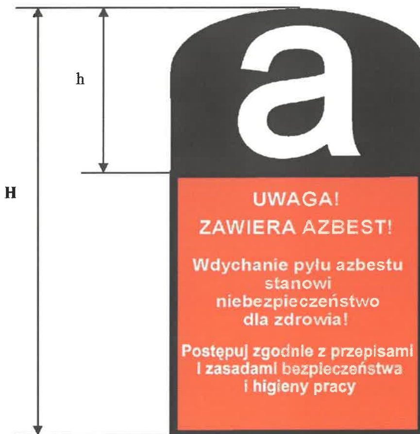
Rysunek 7. Wzór oznakowania wyrobów, odpadów i opakowań zawierających azbest lub wyroby zawierające azbest, a także miejsca ich występowania.
